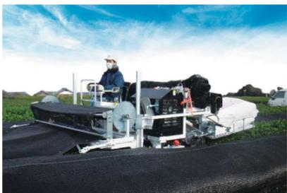
茶直掛け栽培用被覆資材の被覆・除去装置
